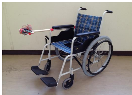
図6 車いすに搭載した超音波検知装置
