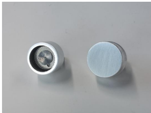
図2 開放型超音波センサ(左)と防水型超音波センサ(右)
