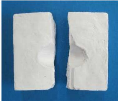
図10 石こう型の破損例
