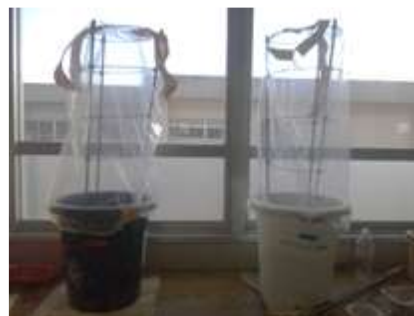
写真 6 有菌土と無菌土を 10ℓ の鉢に入れ、支柱と透明なビニール袋を被せ半密閉状態にして、日当たりの良い室内で 48 時間の CO 2 濃度測定を行った
