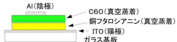
図1. 採用した有機薄膜太陽電池の構造
