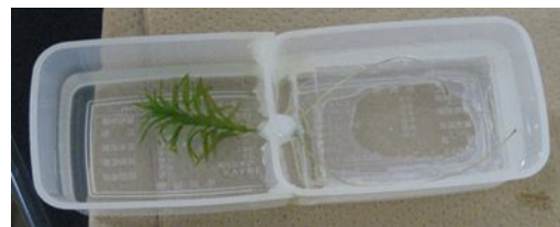
図1 オオカナダモの無機栄養の取り込み部位を組織別に調べるための処理チャンバー。
