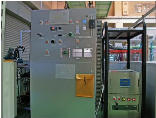
図5. 改造後の液化ユニット(左)、流量計ユニット(右側ラック中ほど)、および冷却ユニット(右側ラック下)。
