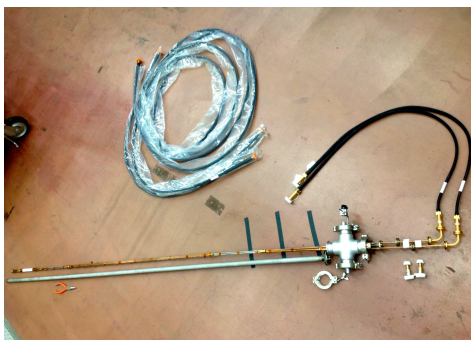
図5：角形導波管プローブとフレキシブル導波管
