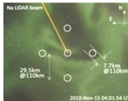
図 1: FPI の観測領域（白丸で囲まれた 5 点）と観測対象のオーロラパッチ（黄線は他装置から照射されたレーザー光）
