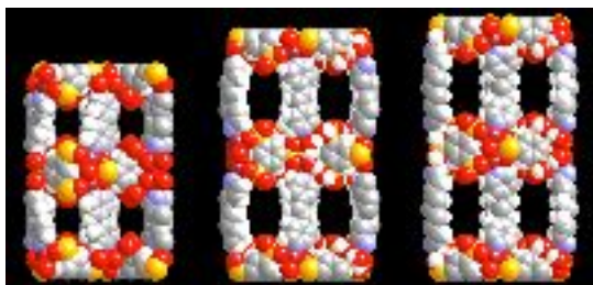
図7 CuBP-bpy(左)、CuBP-bpe(中)、CuBP-bpp(右)のピラードレイヤー構造(層間ゲスト種は省略)
