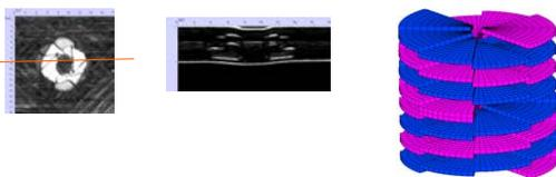
図1 超音波探傷により得られたCFRP積層平板の横衝撃による損傷形状と有限要素モデル
