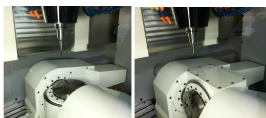
(a)実験前 (b)駆動後 図7 バイナリ運動作動結果
