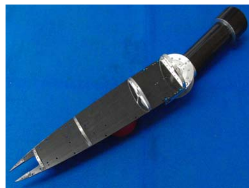
図 8 製作した脚機構
