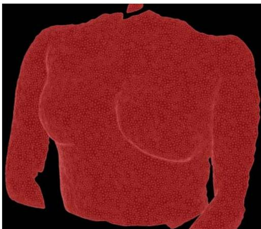
図 1. レーザースキャナーで計測した患者の上半身の3次元形状点群データ
