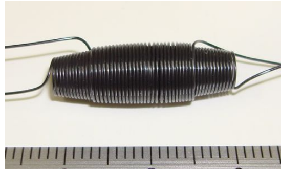
図 2. 中心部二重コイル・出荷時の状態。実験においては、コイルの両端に伸びるワイヤーを切除して用いる。
