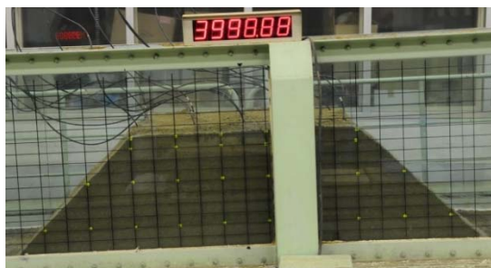
写真2 2度傾斜（右側が高い）の水路人工水路上に作製した天然ダム模型の一例（ダム模型前面および後面の傾斜は、水路底面に対して 45.0 度に設定）
