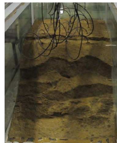
写真3 緩詰め天然ダムの前面傾斜を 45.0 度に設定した場合の決壊の様子 a) 浸透水が前端部下位より滲出、b) 末端部より小崩壊が発生、c) 崩壊が前斜面上位へと後退して全体が決壊
