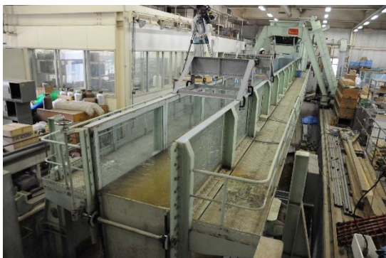
写真1 天然ダムの決壊実験に使用した国内最大級の人工水路（長さ 20m 超、幅 1m）
