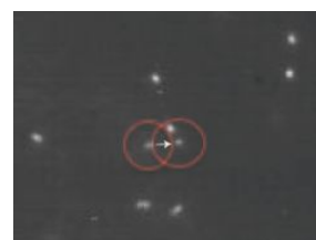
図 6 コロイド結晶内における不純物粒子のホッピング拡散.( t=0 と t=3.5 sの画像の重ね合せ)
