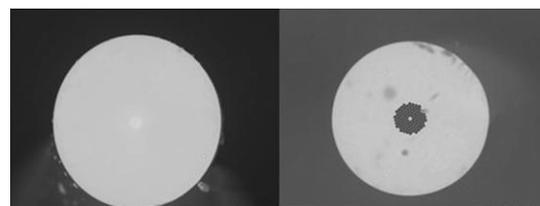
図2 (左)通常の光ファイバ・ (右)フォトニック結晶ファイバの電子顕微鏡写真(SEM)
