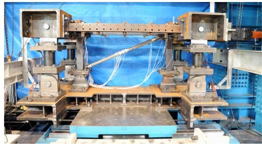
図17 鋼構造架構の荷重実験
