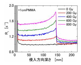
図1. 炭素線照射時のナノクレイ添加二クロム酸 ゲル線量計の R,分布
