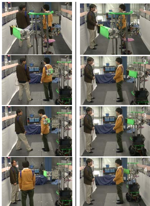
軽接触による移動誘導に基づく通路確保
