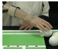
図2 機能試験中のハプティクス義手
