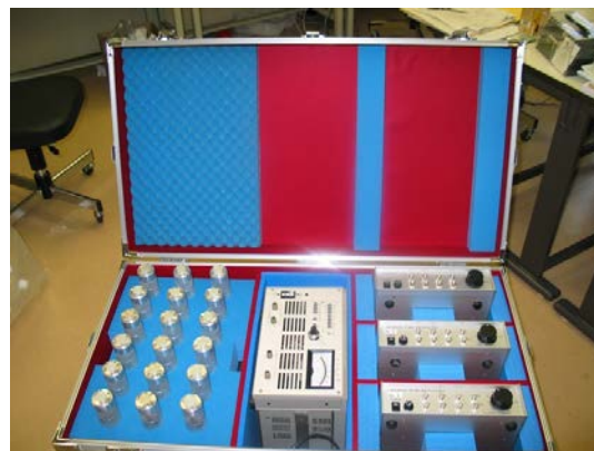
図1 試作された超音波音速CTの実験装置を構成する機器群(専用輸送ケースに格納された状態)
