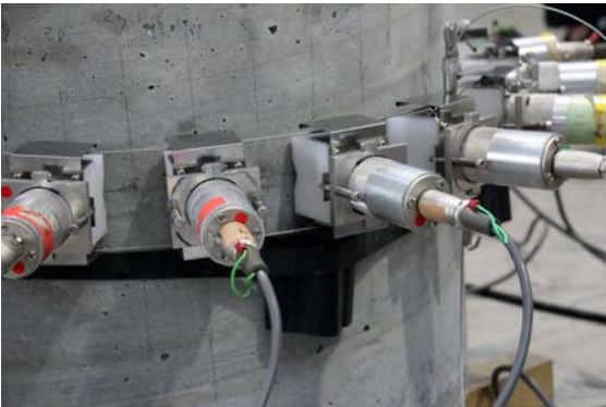
図9 超音波プローブをモルタル円柱に固定されている様子。ホルダーのバネによってシリコンゴムキャップの取り付けられたプローブ先端が円柱表面に押し付けられている。コネクタ部（キャノン4P）には専用のアクリル製防滴用カバーが装着できる。
