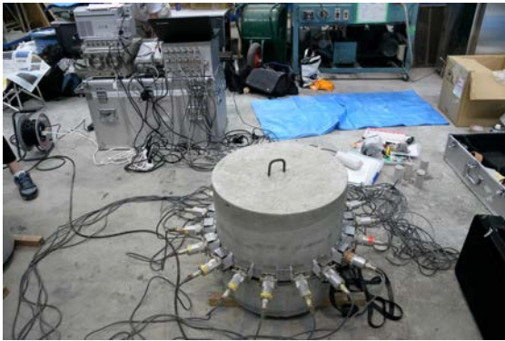
図8 探査実験の様子。モルタル円柱の周囲に18本の超音波プローブが専用ホルダーとワイヤーとで固定されている。
