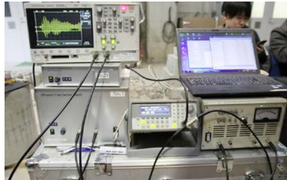
図5 開発された超音波音速CTシステムを構成する機器群（運搬用ジュラルミンコンテナの上に置かれている）。デジタルオシロスコープ（左側上段）、スイッチボックス用電源ユニット（左側中段）、18chスイッチボックス（左側下段）、信号発生器（中央）、制御用コンピュータ（右側上段）、電力増幅器（右側下段）。
