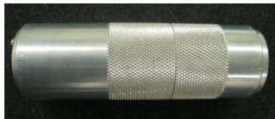
図6 超音波プローブの外観。コネクター部の電極以外のモジュールはプローブ内に密閉収納されており、防滴構造になっている。
