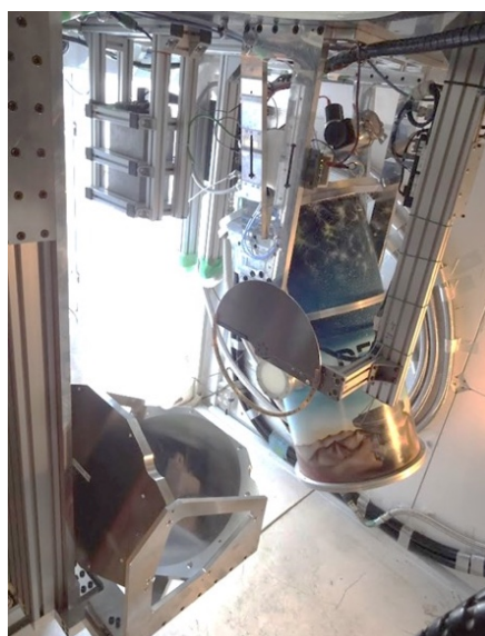
図4：サブミリ波望遠鏡 ASTE の受信機室内に搭載された DESHIMA デュワー。
