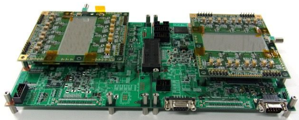
図 3. 開発したデジタル回路基板にセンサー基板を接続した状態
