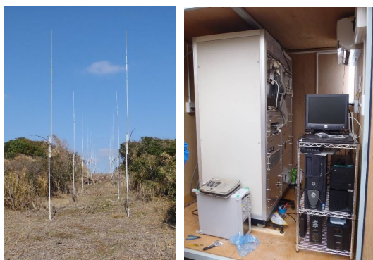
対馬局の受信アンテナ列と海洋レーダシステム。
