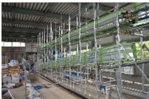
図 7 限界長を測定するための大型土槽試験装置
