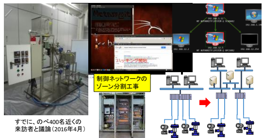
図 4. サイバー攻撃のデモンストレーション装置
