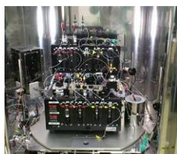
図1. マイクロリアクター合成装置
