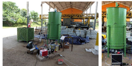
図2 インドネシアにおける石炭鉱山敷地内に設置した低品位炭の自然発火測定用オンサイト試験装置(右:サイロ型試験装置)
