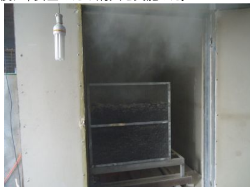
図4 中国のオンサイト試験において観測された低品位炭の発煙 (2014年8月)
