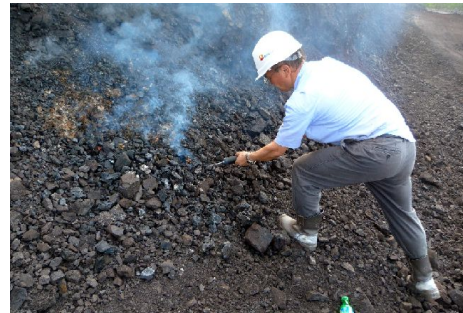
図1 インドネシア石炭鉱山における低品位炭パイルにやける自然発火の状況(2013年9月)
