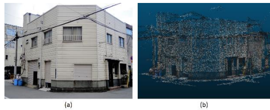
図6 SfMによる復元結果(a:対象構造物, b:復元モデル)
