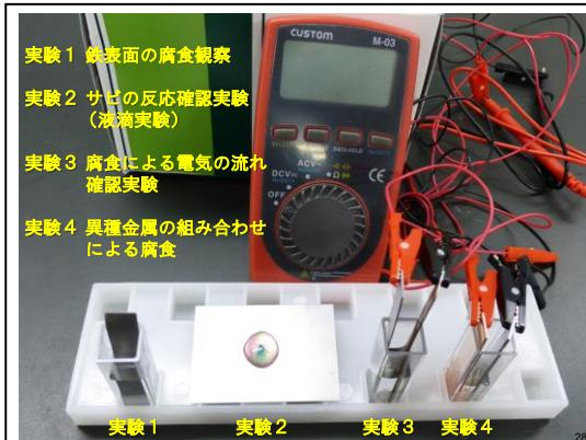
図 2. 作製した腐食防食マイクロスケール実験教材例
