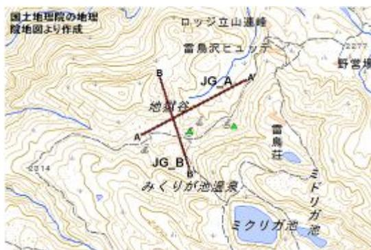
図 3: 多電極電気探査の測線位置図。緑の三角は噴気温度連続観測点。
