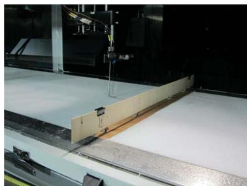
図8 熱線風速計を用いた防雪柵模型周辺の風速計測。対象とした柵の空隙率が0%であるため、実験では無孔板を用いている
