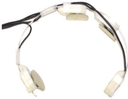
図2 ECG・PPG 一体型スマートバイオセンサ
