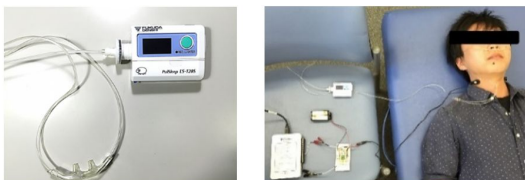
図7 鼻圧と口腔咽喉音の同時計測
