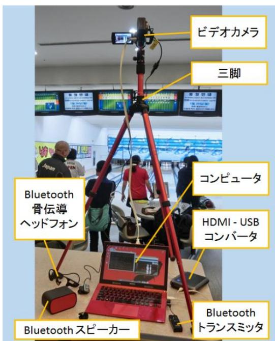
図4 残ピン読み上げシステムの外観
