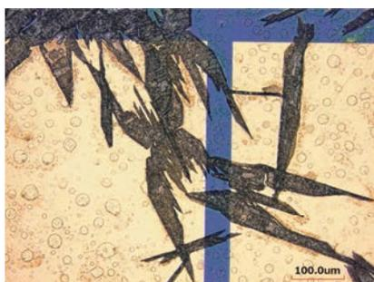
図7, 溶媒噴出法によって作製したCuBrBu微結晶
