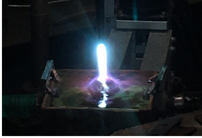
図6 燃焼炎による製作した Co-Cr 人工股関節骨頭へのナノ結晶ダイヤモンド皮膜合成実験画像
