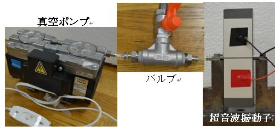
図 13 試作した真空チャック付き超音波振動子と周辺装置
