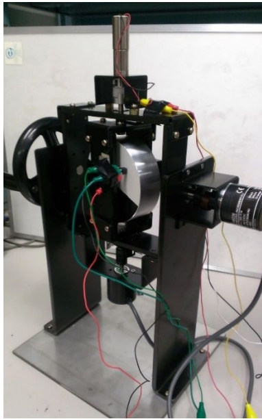
図3 コマ式ジャイロ発電機の写真
