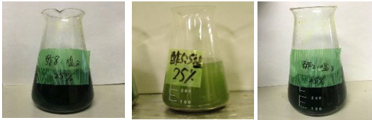
酢酸8:塩酸2 酢酸5:塩酸5 酢酸2:塩酸8 写真-4 各溶液の溶解2日後の様子(濃度25%)
