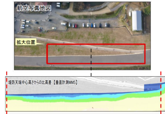
図9 堤防の標高差の解析例 赤の破線は200mの間隔を示す
