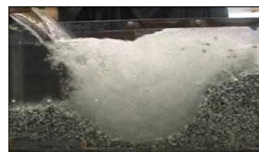
写真-1 下部水槽内の洗掘発生状況 ( d_{50}=20\text{mm} , h_1=0.18\text{m} )
