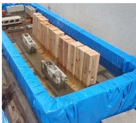
写真1 柱-土台接合部の海水浸漬の様子
