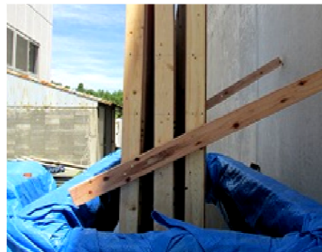
写真2 耐力壁試験体の海水浸漬の様子
