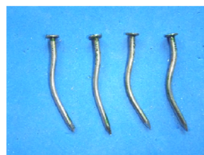
写真5 1日養生後（室内環境）試験体の試験終了後の釘の状態
