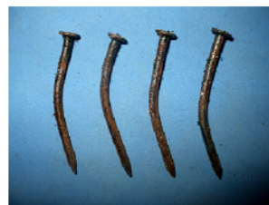
写真6 6か月養生後（密閉環境）試験体の試験終了後の釘の状態
