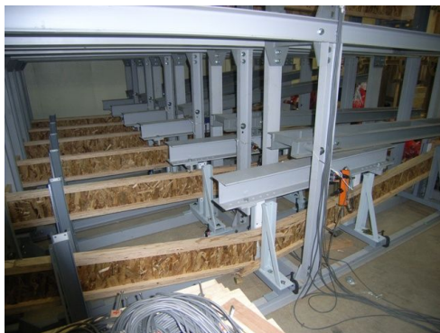
写真1 木質I型複合梁の長期継続荷重載荷試験の様子。（建築研究所にて） (解説)一番手前の試験体がクリープ破壊している。試験は恒温恒湿環境下で実施。全試験に要した期間は約2年。
