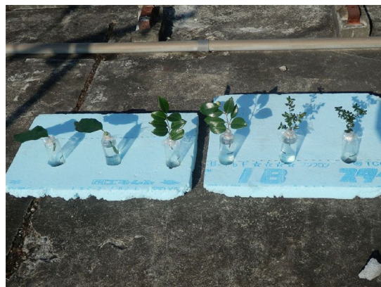
図2 葉の熱伝達係数測定の様子
