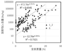
地点 1,2 と地点 6 で値は若干異なるが、 片対数グラフでほぼ同じ傾きで土中の全炭 素量と放射性 Cs 含量が関係している。この ような傾向が現れるメカニズムについては、 溶存有機物が Cs 移動の担体となるいわゆ る colloid facilitated solute transport の可能性と有機物が粘土等の鉱物の表面を 覆うことで、Cs の土壌中の吸着特性を変え
