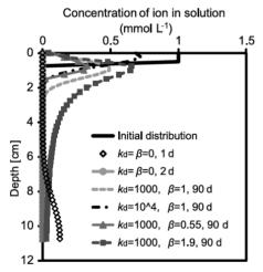
この図は、土壌中の Cs の移動が移流分散 方程式に従うとして、一定の流束で水が下 方浸透している場合を想定し、数値モデル (Hydrus-1D)で計算した結果で、深さと土 中水中の溶存 Cs 濃度を示している。
