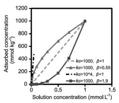
溶液濃度 1mmol/L に対して吸着量1000mmol/kgという1点の吸着データがある場合,線形の吸着等温線と溶液中の Cs濃度に対して凸もしくは凹の曲線を示すFreundlich 型吸着等温線を仮定したときの土中のイオンの移動を考える。よく用いられる線形吸着(S= kd C)を仮定すると図中の破線のような吸着特性になる。一方、Freundlich式を想定すると、 <1の時は、上に凸な曲線(図中)を描き、 >1の時は凹形の曲線(図中)となる。ここでkdは、選択係数である。
