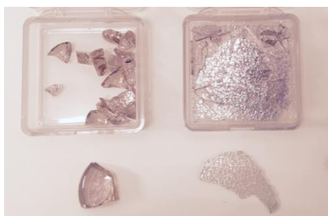
図5：ガラス質近赤外発光素子 1.0\text{Yb}_2\text{O}_3\text{-1.0Nd}_2\text{O}_3\text{-48.5Bi}_2\text{O}_3\text{-48.5B}_2\text{O}_3\text{-1.0Sb}_2\text{O}_3
