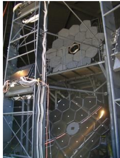
図 1: TA 実験で現在稼働中の従来型の蛍光望遠鏡。2 台の望遠鏡が 2 段重ねになっている。
