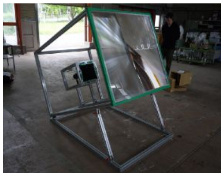
図 2：組み立てた蛍光望遠鏡。観測では、周囲を遮光シートで覆う。
