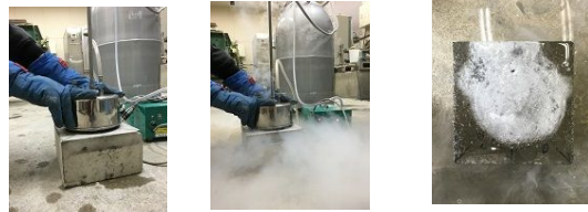
平板供試体に吹付け装置を設置した状況 液体窒素を吹き付けている状況 吹付け装置を外した直後の平板供試体表面
