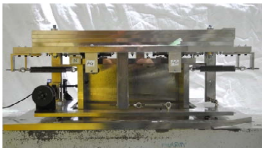
図 13 大質量比 TMD を有する高層免震建物を模擬した振動台実験用モデル (写真)
